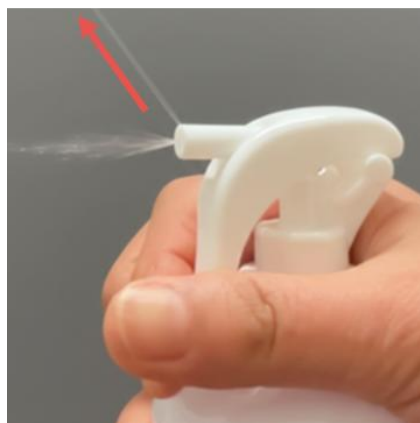
上方向の亀裂の場合：予期せぬ方向への噴出
