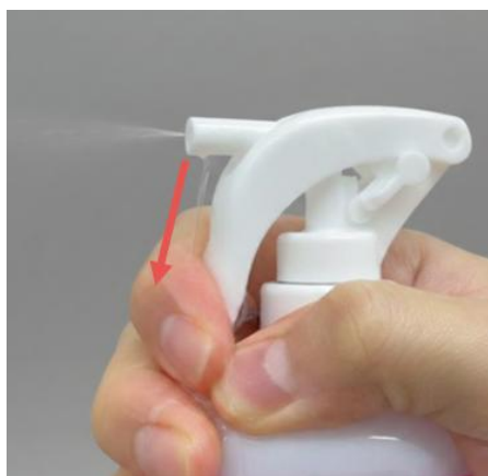
下方向の亀裂の場合：液だれ
